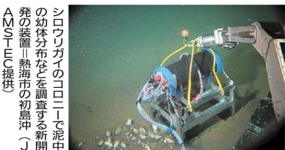
観測に成功したのは初島沖の相模湾の深海（水深約900～1200m）にあるシロウリガイのコロニー。国立研究開発法人海洋研究開発機構（JAMSTEC）の有人潜水調査船「しんかい6500」に乗り込み、ロボットアームを使って高周波の超音波を発して泥の中に埋まっている幼体の様子を3次元的に非接触で確認した。
